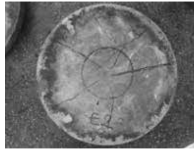
Hình 6. Thí nghiệm sức kháng va chạm: a) Mô hình thí nghiệm; b) Mẫu thí nghiệm va chạm và bi thép D50mm; c) Mẫu HPFRC sau khi va đập 45 lần (N2); d) Mẫu Sika bị phá hủy (N1). Kết quả thí nghiệm được thể hiện trong bảng sau:
