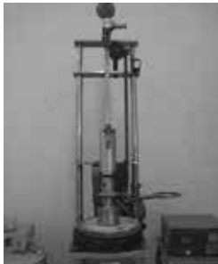
Hình 6. Thí nghiệm sức kháng va chạm: a) Mô hình thí nghiệm; b) Mẫu thí nghiệm va chạm và bi thép D50mm; c) Mẫu HPFRC sau khi va đập 45 lần (N2); d) Mẫu Sika bị phá hủy (N1). Kết quả thí nghiệm được thể hiện trong bảng sau:
