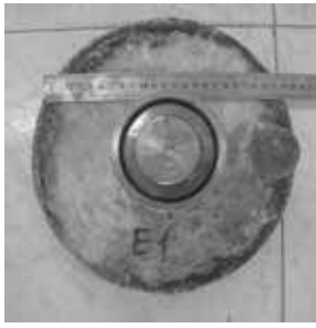
Hình 6. Thí nghiệm sức kháng va chạm: a) Mô hình thí nghiệm; b) Mẫu thí nghiệm va chạm và bi thép D50mm; c) Mẫu HPFRC sau khi va đập 45 lần (N2); d) Mẫu Sika bị phá hủy (N1). Kết quả thí nghiệm được thể hiện trong bảng sau:
