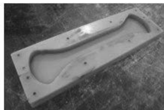
Hình 4. Thí nghiệm kéo trực tiếp mẫu vữa HPFRC: a) Khuôn đúc mẫu; b) mẫu "dog-bone" thí nghiệm kéo trực tiếp; c) Thí nghiệm kéo; d) Bề mặt mẫu bị kéo đứt
