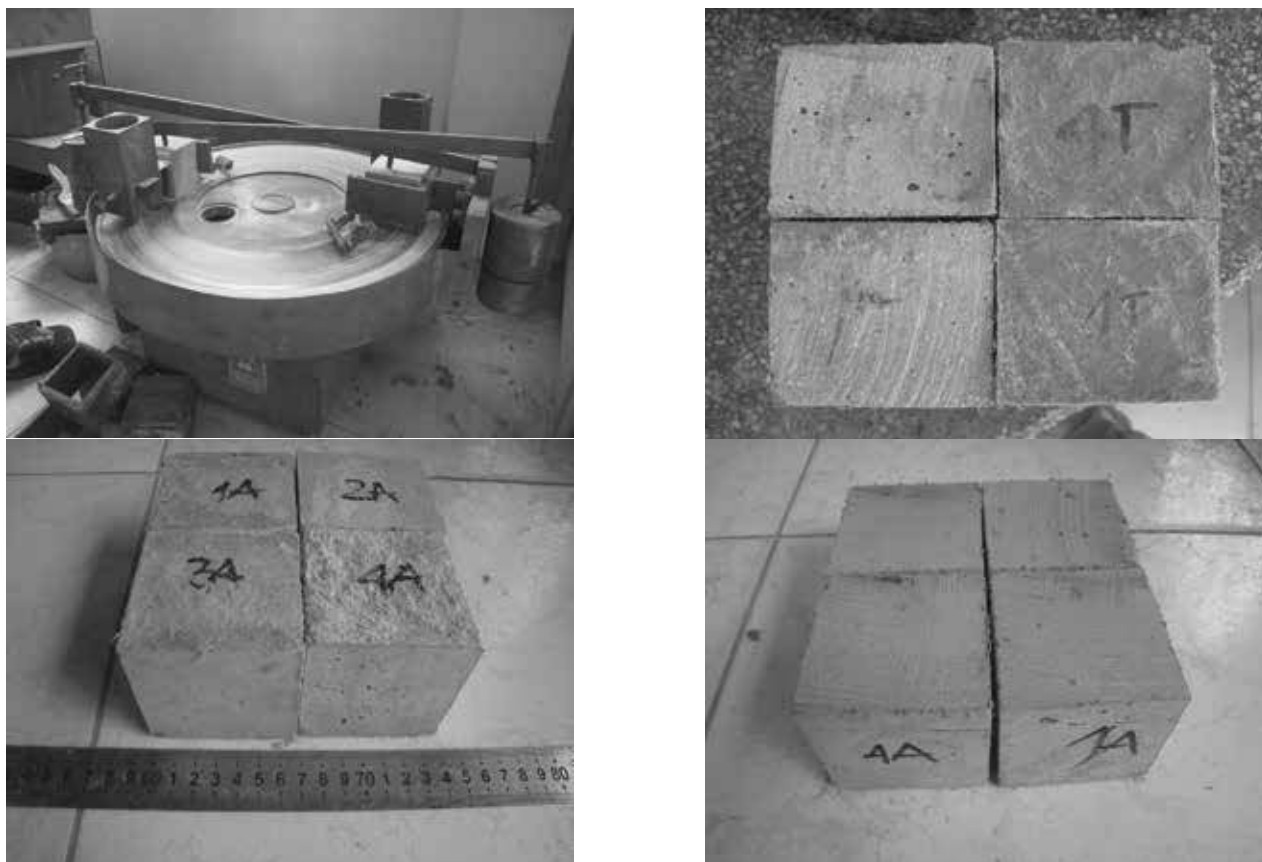
Hình 7. Thí nghiệm mài mòn: a) Thiết bị mài mòn; b) Mẫu sau/trước khi mài mòn - 91 ngày; c) Mẫu trước khi mài mòn - 14 ngày; d) Mẫu sau khi mài mòn - 14 ngày
