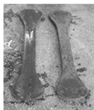
Hình 4. Thí nghiệm kéo trực tiếp mẫu vữa HPFRC: a) Khuôn đúc mẫu; b) mẫu "dog-bone" thí nghiệm kéo trực tiếp; c) Thí nghiệm kéo; d) Bề mặt mẫu bị kéo đứt
