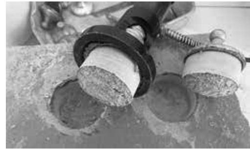
Hình 5. Thí nghiệm bám dính giữa vữa HPFRC và BTXM thông thường: a) Khoan mẫu; b) Gắn đĩa thép và thiết bị gia tải kéo; c) Dạng phá hủy ở nền bê tông
