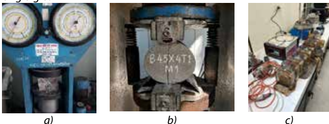
Hình 2. Các thí nghiệm: a) - Cường độ chịu nén; b) - Cường độ chịu kéo khi bừa; c) - Đo điện lượng thẩm ion clorua
