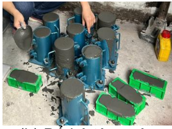
(b) Đổ bê tông vào mẫu trụ.
