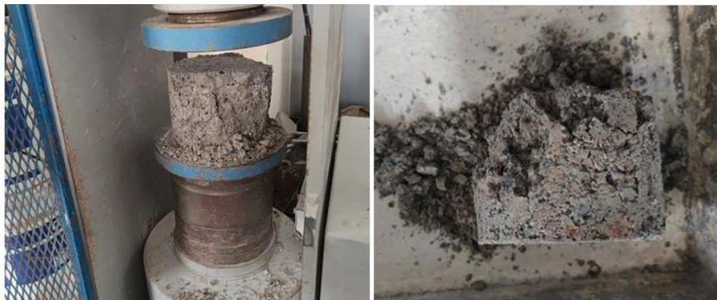
Hình 8. Thí nghiệm xác định cường độ nén của hỗn hợp RCA gia cố xi măng
