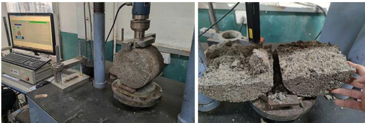
Hình 11. Thí nghiệm xác định cường độ ép chẻ của hỗn hợp RCA gia cố xi măng
