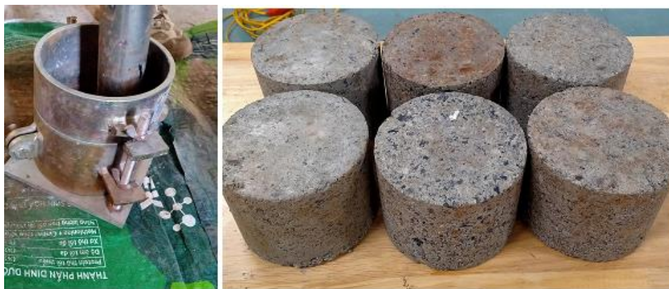
Hình 7. Chế bị mẫu RCA gia cố xi măng để xác định cường độ nén và ép chế
