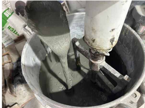
Hình 2. Thiết bị trộn cưỡng bức 4 cấp độ tại phòng thí nghiệm.
