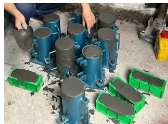
(b) Đổ bê tông vào mẫu trụ.
