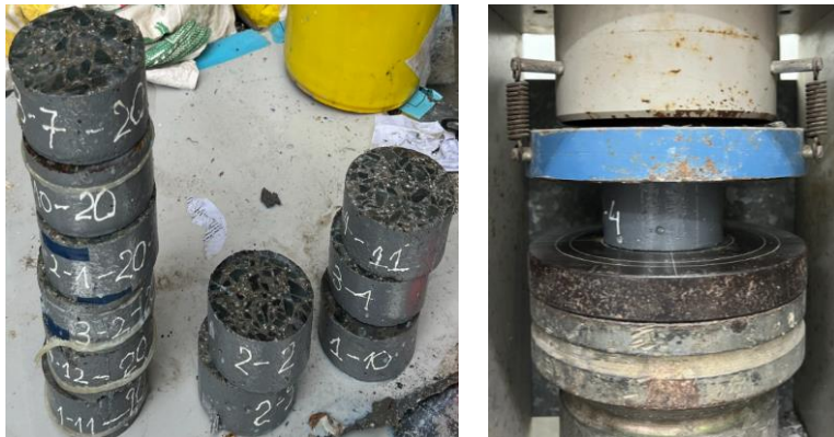
Hình 1: Các mẫu thí nghiệm thấm clorua và sơn xung quanh mẫu bằng keo Silicon.
