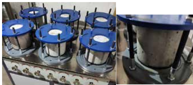
Hình 1. Thí nghiệm thấm mẫu BTXM theo TCVN 3116
