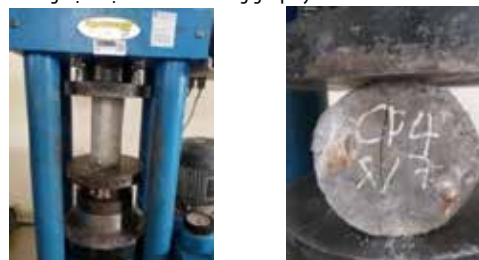
Hình 2. Thí nghiệm cường độ chịu nén và thí nghiệm ép chéo
