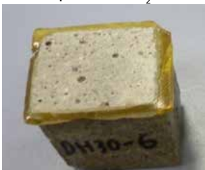
Hình 1. Mẫu lập phương được phủ nhựa epoxy
