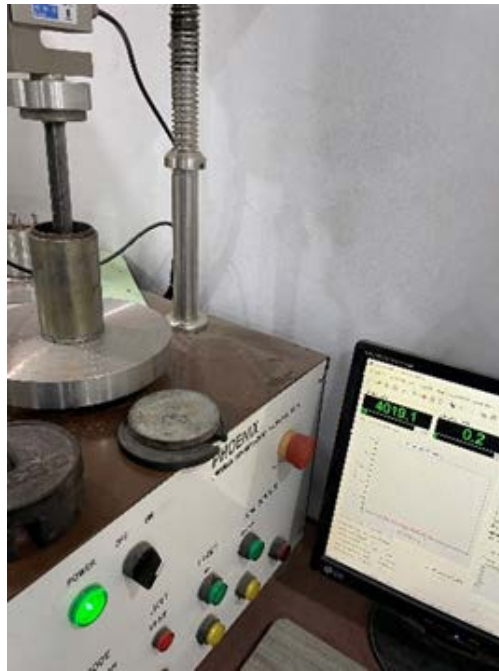
Hình 3. Quá trình chế tạo mẫu bằng phương pháp nén tĩnh trong khuôn thép
