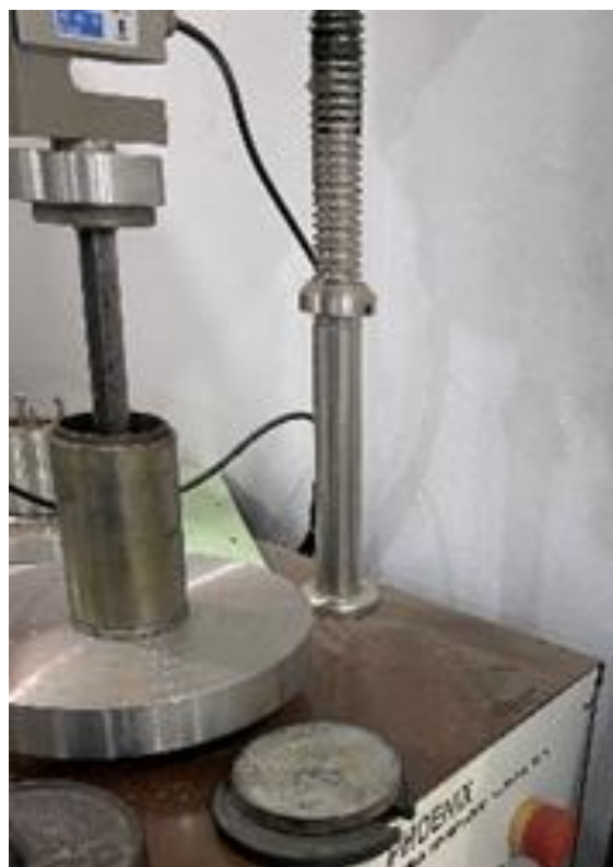
Hình 3. Nén tĩnh trong quá trình chế tạo mẫu
