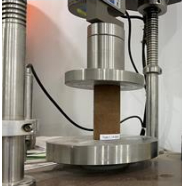
Hình 4. Thí nghiệm nén một trục mẫu đất nén
