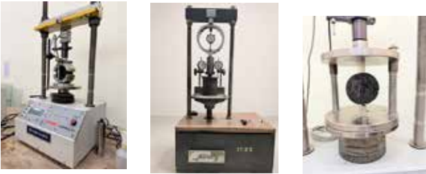
a) - Thí nghiệm nén Marshall b) - Thí nghiệm mô-đun đàn hồi c) - Thí nghiệm ép chế
