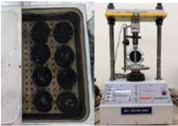
Hình 2. Thí nghiệm độ ổn định và độ dẻo Marshall
